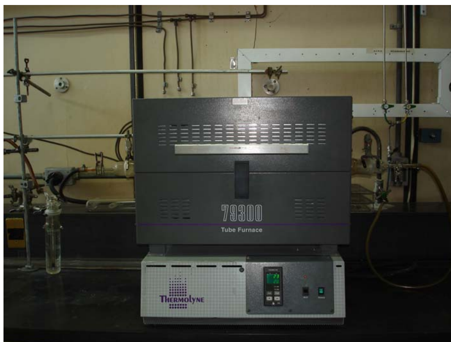
Figura 2.31 Dispositivo experimental empleado para la pirolisis de los compuestos silicato-carbono
