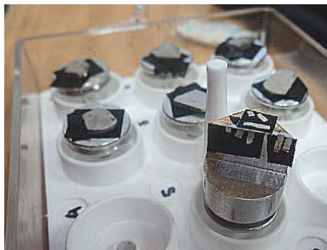
Figura 2.9 Pines planos con muestras en bulto y pin de 45° con cintas.
