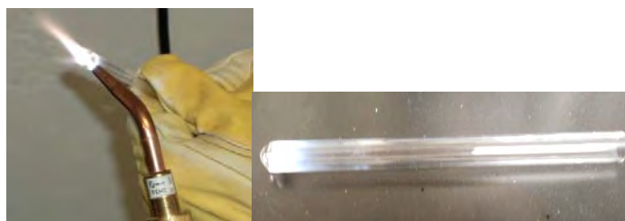
Figura 2.2. a) Sellado de un extremo del tubo b) Tubo sellado en un extremo.
