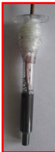
**Figura 6.2.** Imagen del electrodo de pasta de carbón preparado.
