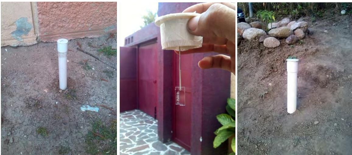
Figura 3.7 Dispositivo de medición CR – 39.
