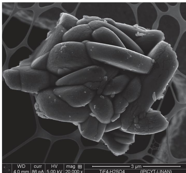
**Fig. 35.** Imagen de SEM de estructuras jerárquicas sintetizadas a partir de  $\text{TiF}_4$  y  $\text{H}_2\text{SO}_4$ .
