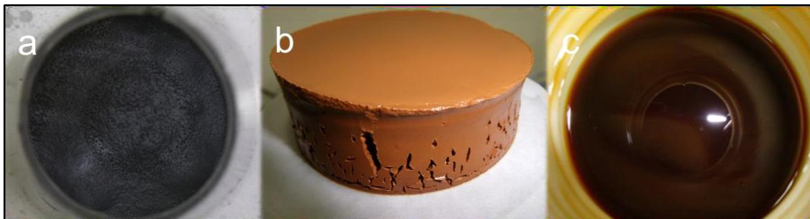
Figura 3.1 Imágenes de preparación de GO realizado: (a) etapa de expansión en volumen del grafito precursor (b) producto de la reacción después del primer lavado (c) cambio de color del producto después de varios ciclos de lavados y centrifugación.
