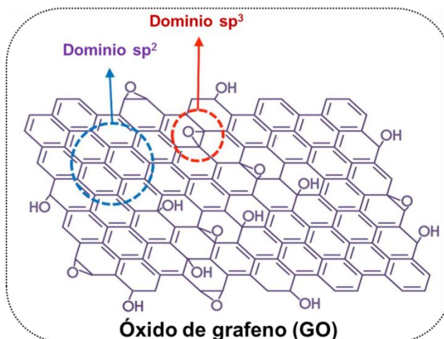
Figura 3.1 Modelo estructural de óxido de grafeno que consiste de dominios de carbono con hibridación sp^2 y sp^3 .
