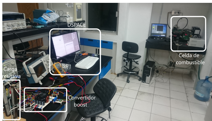
Figura 4.2: Prototipo experimental de laboratorio conformado por celda de combustible, convertidor elevador, DSPACE y carga resistiva.
