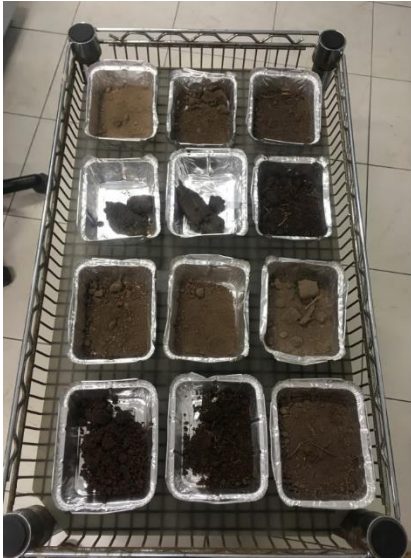
Imagen 2.19: Fotografías de algunas muestras de suelos que fueron deshidratadas, tamizadas de la biomasa radical y las rocas presentes para determinar la densidad aparente en tres profundidades diferentes.
