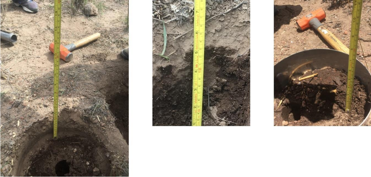
Imagen 2.9: Fotografías donde se muestra la profundidad a la que llega la infiltración de cada micrositio, post simulación. Se remueve el anillo y se mide hasta donde haya penetrado la humedad.
