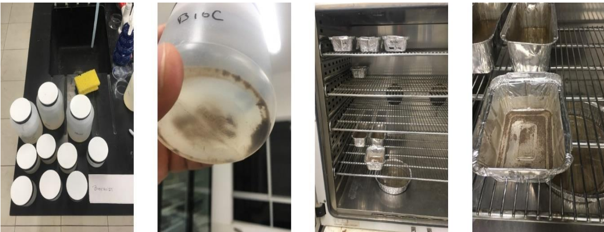
Imagen 2.10: Fotografías donde se muestra la escorrentía recolectada, se deshidrató el agua de la muestra para cuantificar la cantidad de suelo colectada de cada micrositio.
