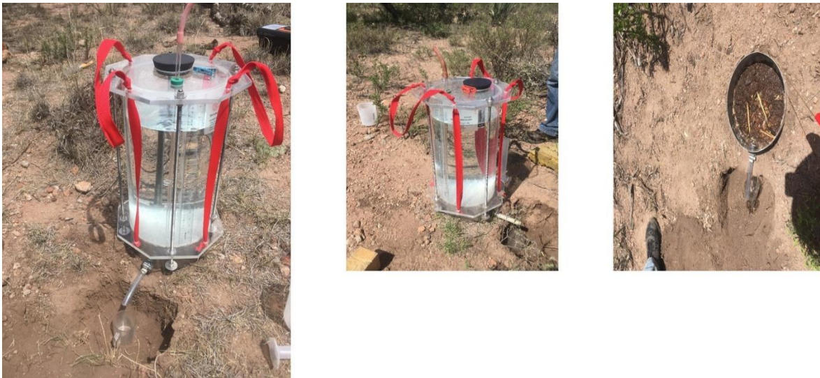
Imagen 2.8: Fotografías del simulador completamente instalado y la fosa de recolección que se hace en cada parcela para coleccionar la escorrentía producida después de los 30 minutos de precipitación.
