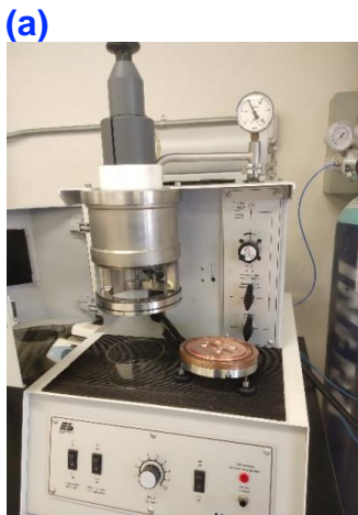
Figura 2.1. (a) Horno de arco eléctrico modelo MAM-1 de la firma alemana Edmund Bülher utilizado para producir las aleaciones en bulto en este trabajo de tesis. (b) Representación esquemática de la base de cobre donde se encuentran los crisoles para la fundición del horno de arco eléctrico utilizado; imagen obtenida de [1].
