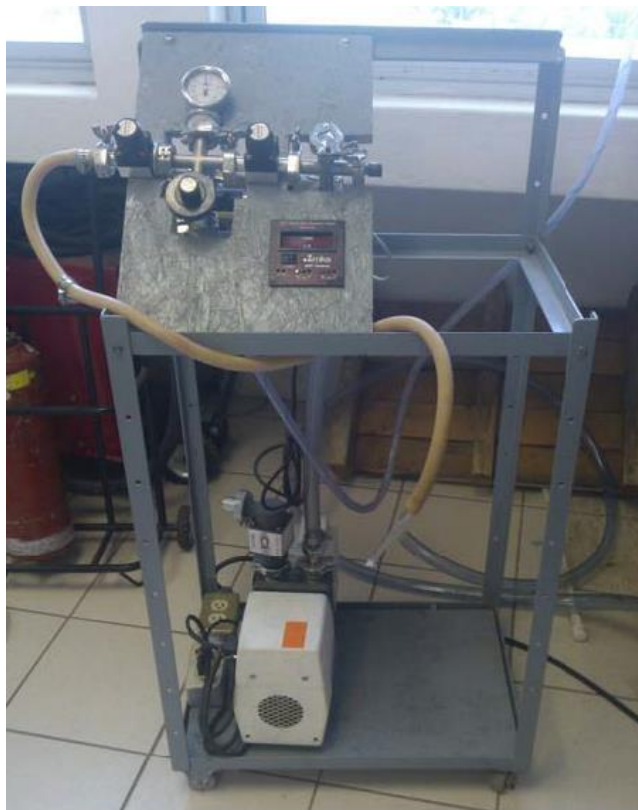
Figura 2.3. L3nea de vac3o con entrada de Ar UHP, con la cual se encapsularon las muestras al vac3o dentro de los tubos de cuarzo.
