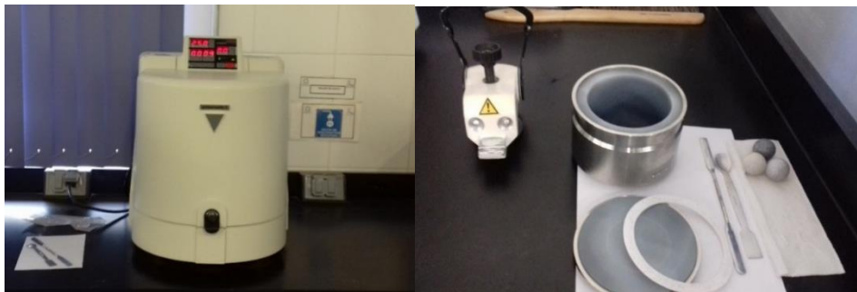
Figura 17. Molino planetario Pulverisette 6 de ágata marca Fritsch.
