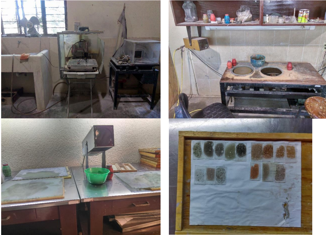
Figura A.1 a) Cortadora con disco de diamante; b) Discos metálicos giratorios para pulido de muestras; c) Vidrios para pulido ; d) Láminas delgadas terminadas.
