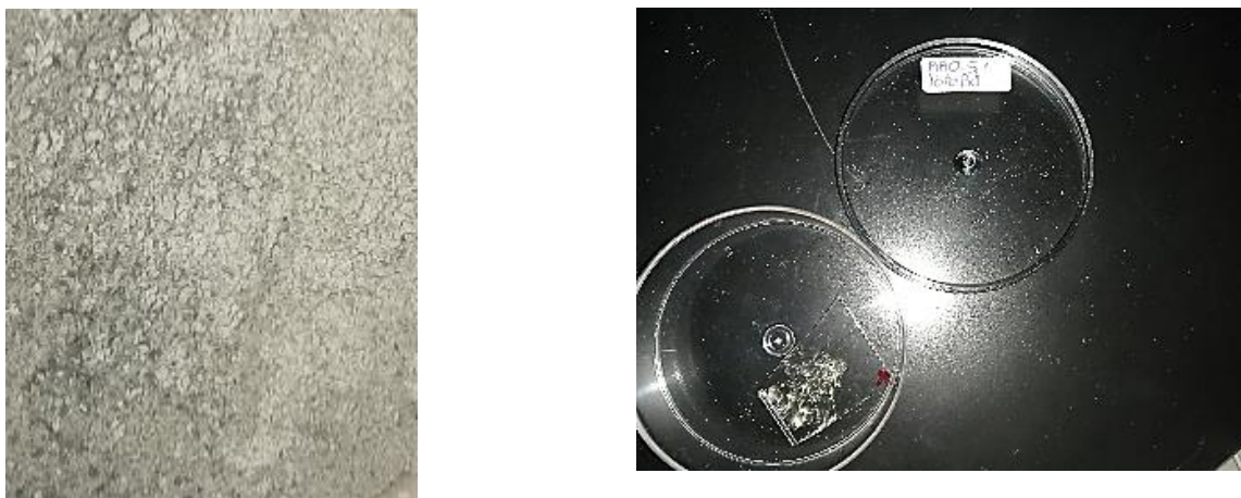
Figura 58. Apariencia física del material, a) antes y b) después del contacto con Cromo de 0.5 AACuS
