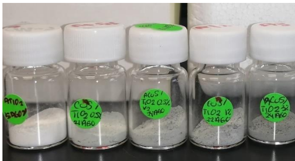
Figura 15. Resultado de síntesis hidrotérmal asistido con microondas de los materiales \text{TiO}_2 y \text{TiO}_2 sintetizados con 0.5, 1 y 3% de CuS.
