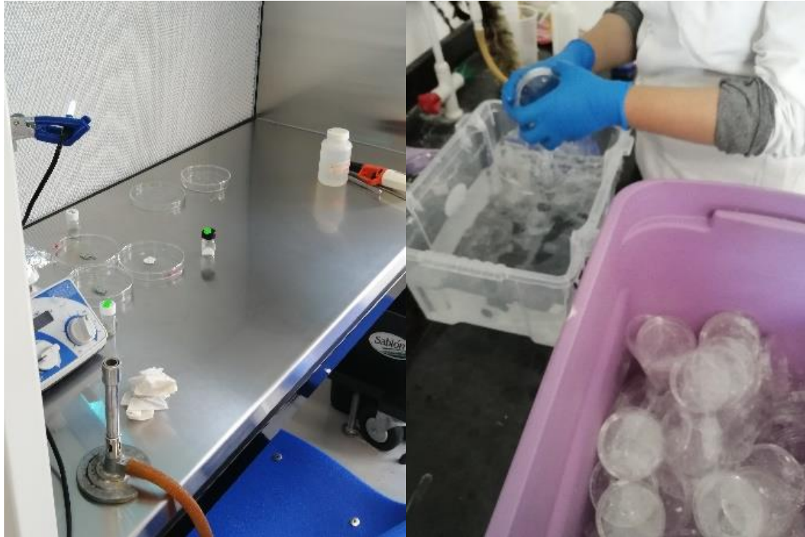
Figura 45. Esterilización de las nanopartículas y material de plástico (cajas Petri, puntas, tubos Eppendorf, tubos Falcon).
