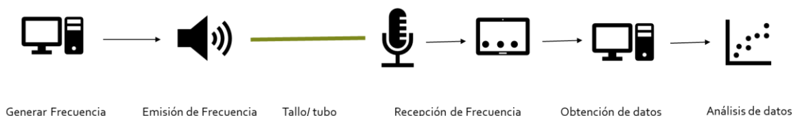
Ilustración 9. Esquema general de los pasos a seguir para desarrollar de forma correcta una metodología que permita conocer los valores de resonancia, frecuencia fundamental y armónicos de tubos y tallos de espinaca.
