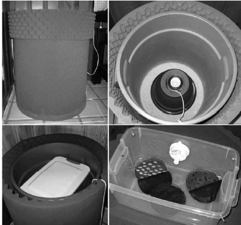
Ilustración 3. Cámara acústica utilizada, la cual consiste en un contenedor cilíndrico forrado de espuma acústica, en el interior de este se colocó arena y un contenedor con un altavoz, en suspensión se colocó un recipiente plástico con 3 cajas Petri, las cuales contienen semillas de okra, zucchini y ambas. Ilustración tomada de la referencia (Katherine Creath, 2004).
