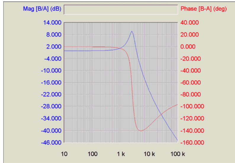
Figura 4.4. Respuesta en frecuencia experimental del circuito RLC propuesto.
