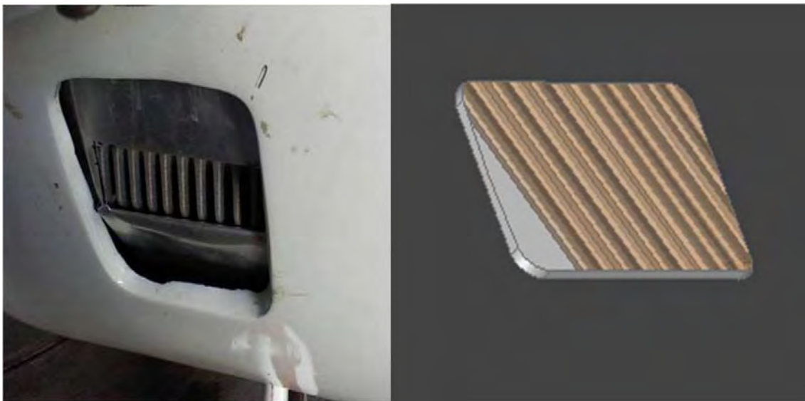
Figura 3.17: Aletas del motor que se encuentran frente a una entrada de aire de la cabina de fuego
