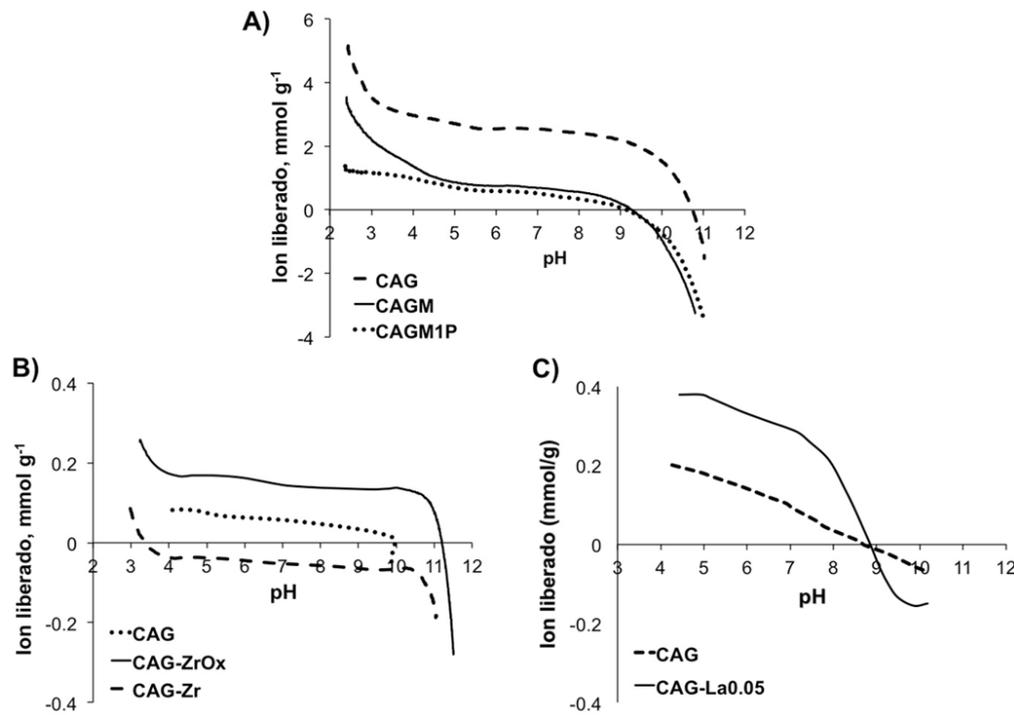
**Figura 5.** Punto de Carga Cero de los carbones activados modificados y sin modificar: **A)** CAGM1P, **B)** CAG-ZrOx, **C)** CAG-La. Los materiales adsorbentes, CAGM y CAG-Zr, se modificaron sin presencia del agente complejante.
