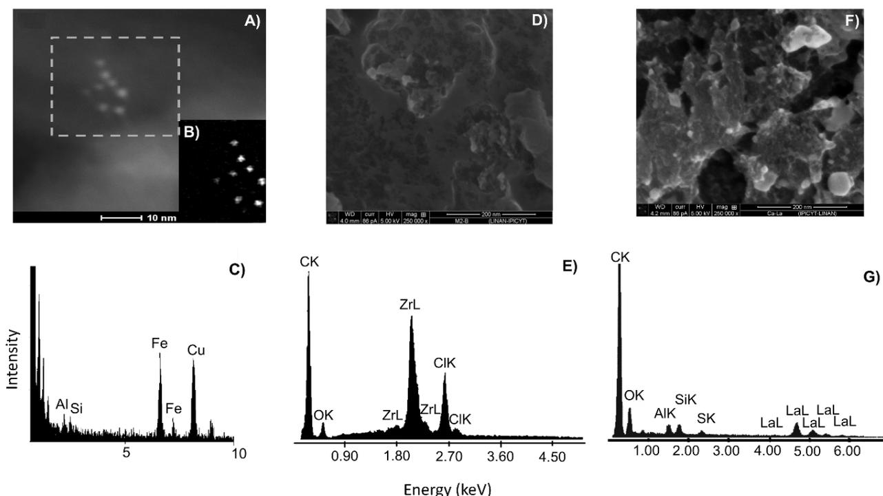
**Figura 4. A y B)** Imágenes de TEM del CAG modificado con hierro y fosfato (CAGM1P), **C)** EDS del CAGM1P, **D)** Imagen de SEM del CAG modificado con zirconio y ácido oxálico (CAG-ZrOx) y **E)** EDS del CAG-ZrOx, **F)** Imagen SEM del CAG modificado con lantano (CAG-La), **G)** EDS del CAG-La.
