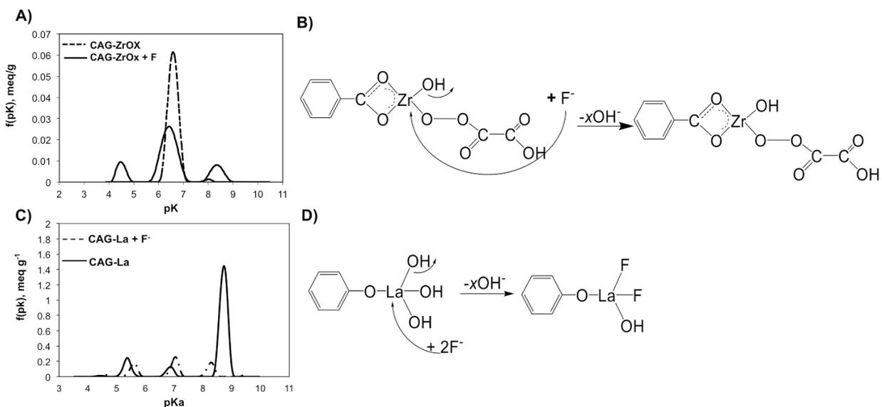
**Figura 6. A)** Distribución de  $pK_a$ s para: CAG-ZrOx y CAG-ZrOx saturado con iones fluoruro (CAG-ZrOx + F) a pH 7 y 25°C, **B)** Posible mecanismo de adsorción de fluoruro (CAG-ZrOx + F), **C)** Distribución de  $pK_a$ s para: CAG-La y CAG-La saturados con iones fluoruro (CAG-La + F) a pH 7 y 25°C, **D)** Posible mecanismo de adsorción de fluoruro (CAG-La + F).
