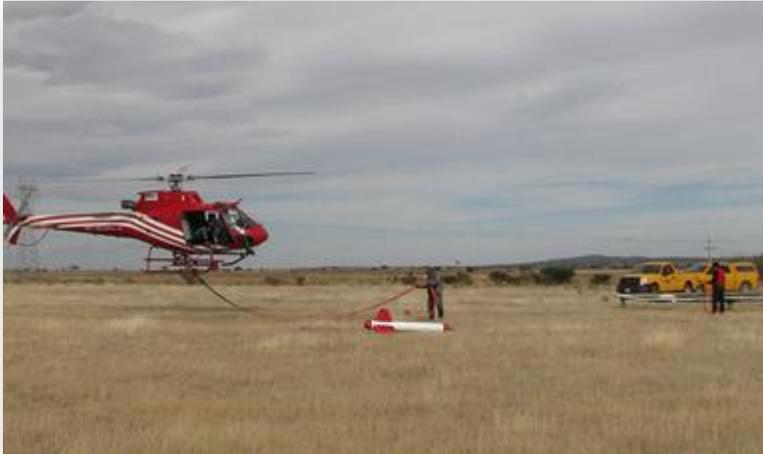
**FIGURA 9.** Equipo de aeromagnética. Imagen obtenida del SGM.
