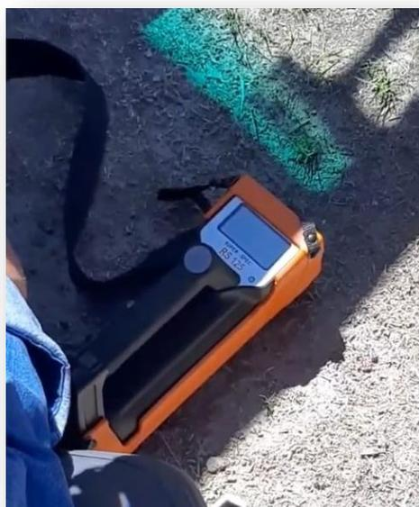
**FIGURA 14.** Equipo de espectrometría de rayos gamma RS 125 Super-SPEC.
