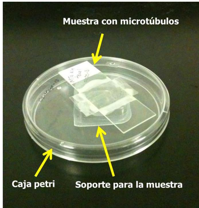
**Figura III.11. Cámara de humedad para poder conservar los microtúbulos.** La muestra está colocada sobre un soporte dentro de una caja petri la cual contiene agua milli Q (agua ultrapura).
