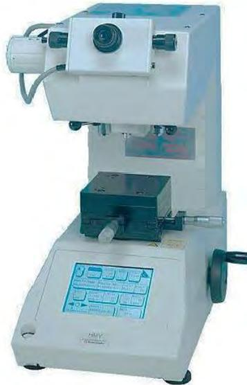
*Figura 2.9 Imagen del Microdurómetro Shimadzu HMV-2 series*
