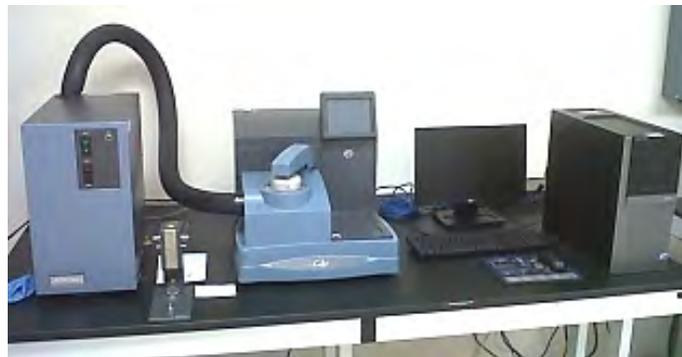
*Figura 2.3* Dispositivo DSC TA 200 utilizado en la caracterización de la aleación.
