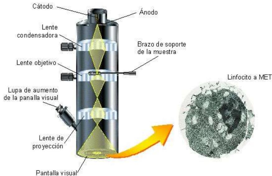
**Figura 2.5** Esquema básico de un Microscopio Electrónico de Transmisión
