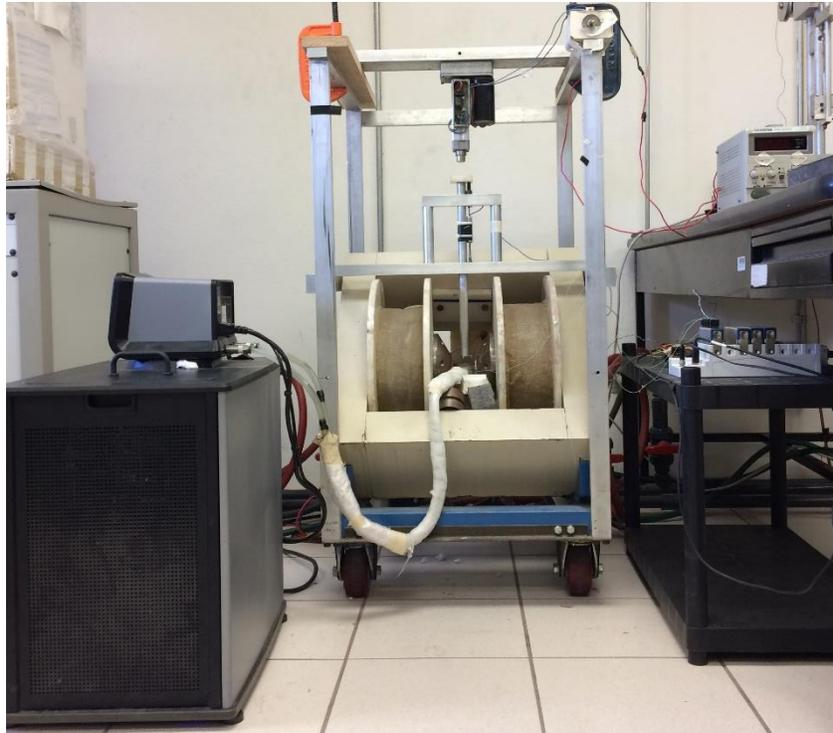
**Figura 2.3.** Equipo para medir el cambio de temperatura adiabático.
