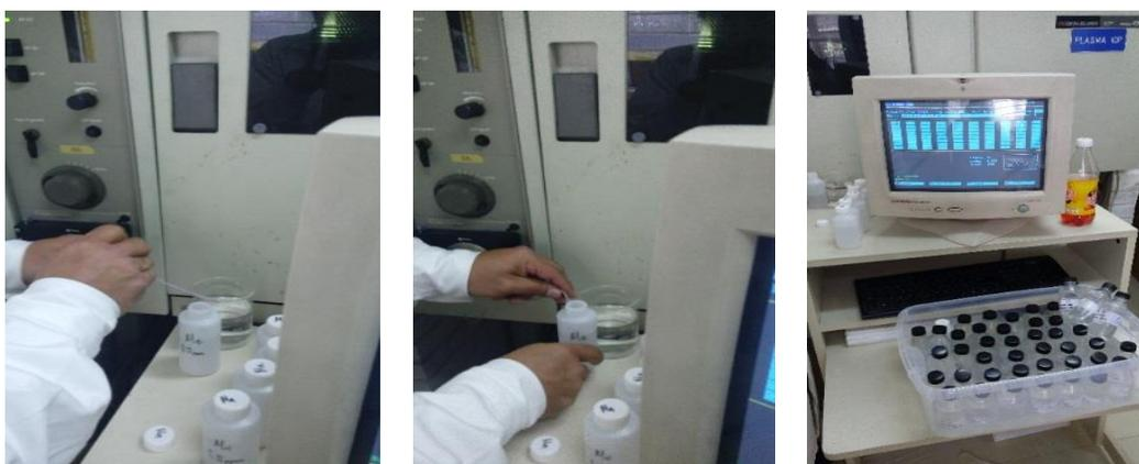
Figura 3.4 Calibración de ICP para determinación de cationes mayoritarios.
