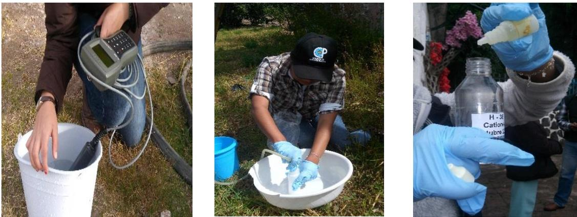
Figura 3.2 Medición de parámetros físicos y colecta de muestras de agua en pozos y manantiales.
