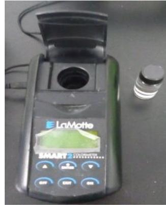
Figura 3.5 Determinación de aniones con el colorímetro SMART 2.
