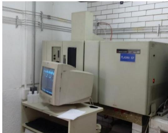
Figura 3.3 Espectro de plasma 400 (ICP).
