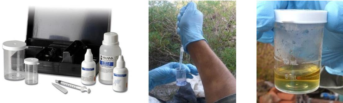
Figura 3.6 Determinación de alcalinidad durante el muestreo.
