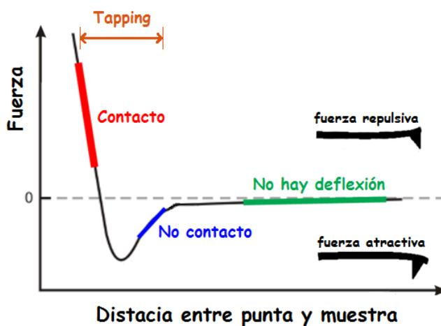
Figura 3.5: Gráfica de fuerza contra separación entre la punta y la muestra en AFM. Se muestran las regiones de medición de modo contacto, no contacto y tapping
