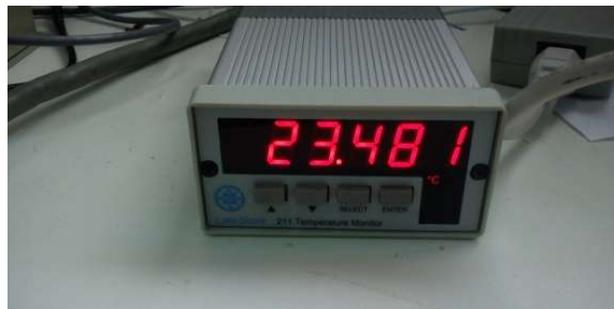
[Figura 1.14](#) Lector digital de temperatura de la firma Lake Shore Cryotronics modelo 211 que permite medir la señal de proveniente del sensor tipo Cernox®. Este instrumento permite transferir las lecturas de temperatura a un ordenador.
