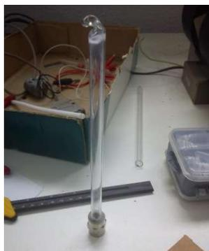
[Figura 1.18](#) Tubo de cuarzo sujeto y sellado para soportar un vacío de  $10^{-3}$  torr.
