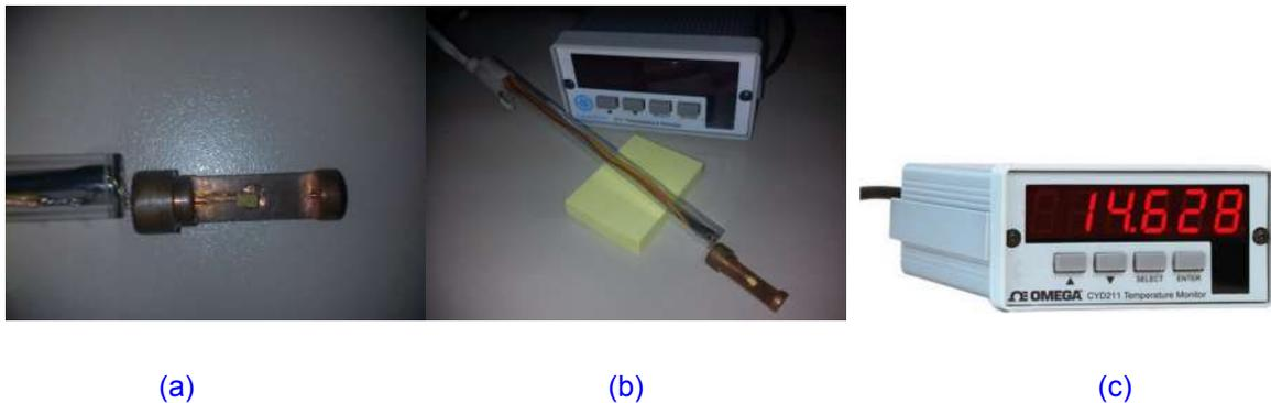
[Figura 1.10](#) (a) Sensor tipo Cernox® sobre un soporte de cobre y conectado a cables que van dentro de un tubo de cuarzo; (b) sensor con el sistema de lectura de datos o lector digital de temperatura modelo 211 [que se muestra en detalle en (c)].
