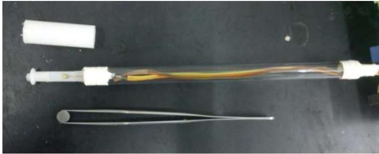
[Figura 1.13](#) Portamuestras en Nylon terminado con el sensor tipo Cernox® instalado. El portamuestras está sujeto a un tubo plástico. En el borde superior izquierdo de la foto se encuentra la cubierta cilíndrica que permite aislar térmicamente el portamuestras. Justo debajo se observan unas pinzas de laboratorio sujetando una muestra de Gadolinio policristalino.
