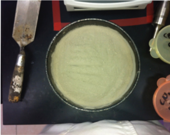
Figura 40 Materiales un tazón de mezclado, una espátula metálica, cemento gris tipo Portland CPC30 nanotubos de carbono y agua.
