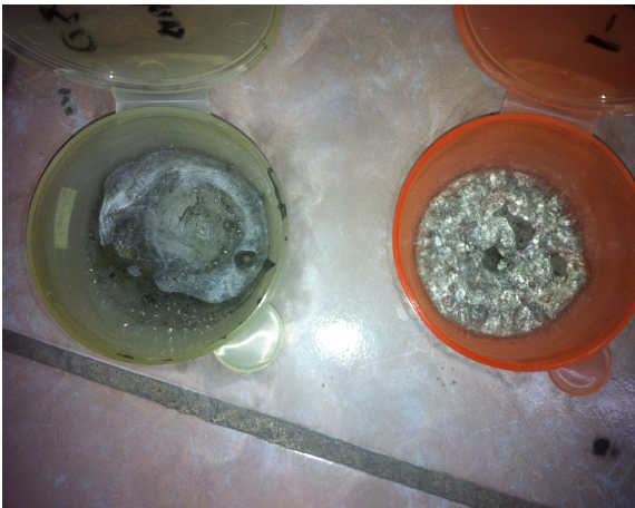
Figura 42 Interrupción de la hidratación utilizando un baño de nitrógeno líquido previo a la cubierta de oro para llevarlo al microscopio electrónico, el proceso se repitió para muestras a 0 hrs, 1 hr, 2hr, 3hr, 4 hr, 5hr, 6hr, 7hr, 8hr, 9hr, 10hr, 11hr, 12hr para cada tipo de muestra, las muestras se componen únicamente de cemento gris, agua y cemento gris, agua y nanotubos de carbono, una muestra para nanotubos de carbono dopados con nitrógeno y nanotubos de carbono dopados con oxígeno.
