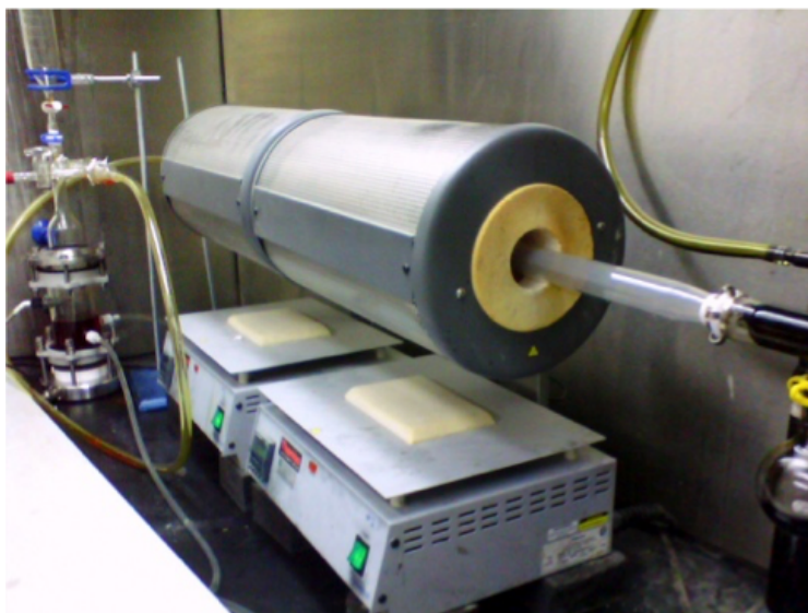
Figura 21 Arreglo de sistema CVD para la síntesis de los nanotubos de carbono dopados con nitrógeno y dopados con oxígeno.
