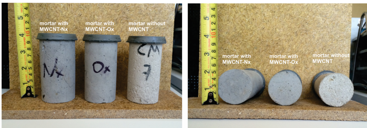
Figura 55 imágenes tipo de cilindros obtenidos para las pruebas a compresión simple, de lado izquierdo se muestra como una referencia de medida de altura (10 cm), en la imagen derecha se muestra una referencia de medida del diámetro (5cm).
