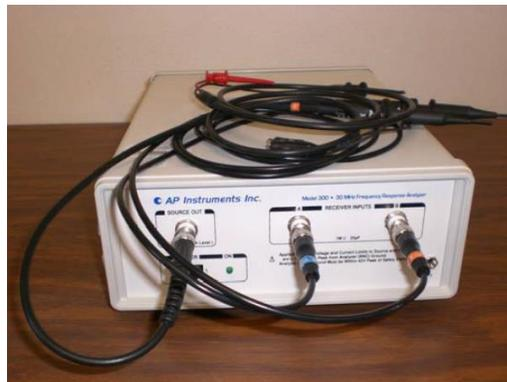
Figura 4.9. Analizador de respuesta en frecuencia 300 de AP Instruments.
