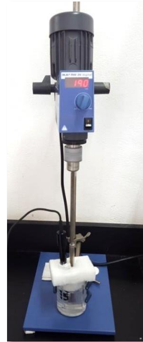
Figura 6.5 Esquema del reactor en lote empleado (izquierda) y fotografía del sistema armado (derecha).
