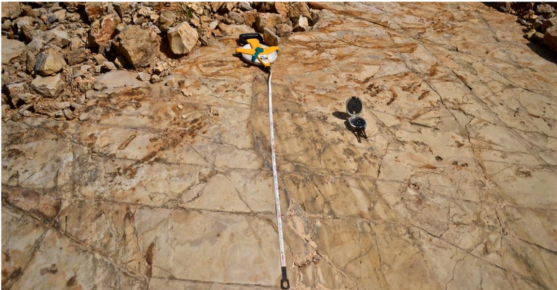
Fig. 4.10 Vista de un plano de estratificación de la Formación Agua Nueva, en donde se puede apreciar la interconexión de las fracturas. (Cinta métrica estirada a 1 m)
