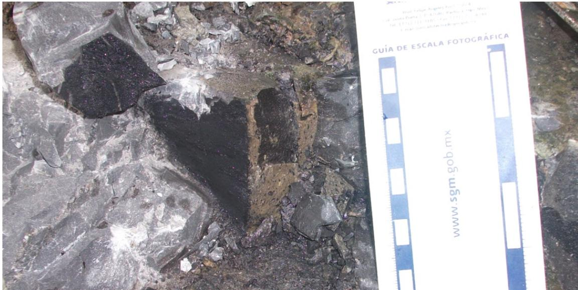
Fig. 4.14 Presencia de impregnación de hidrocarburo en planos de fractura, en Poxtla, en la Formación Agua Nueva.
