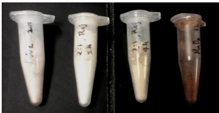
**Figura 3.2** Viales de 1.5 ml con los óxidos seleccionados. Materiales de izquierda a derecha:  $\alpha$ ,  $\gamma$ ,  $\delta$  y  $\beta$
