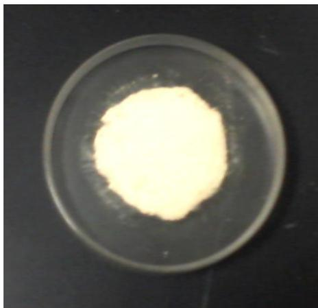
**Figura 2.12.** Portamuestras de ruido cero con material en su superficie.
