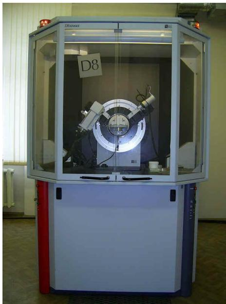
**Figura 2.11.** Difractómetro Bruker D8 Advance.
