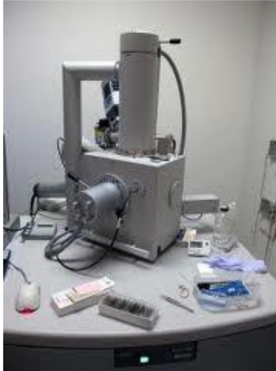
**Figura 2.16.** Microscopio electrónico de barrido marca FEI modelo Quanta 200.
