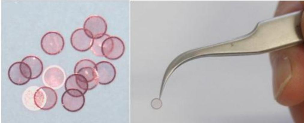
**Figura 2.15.** Rejillas de Cu vistas por ambas caras brillante y opaca [63]. Derecha: Rejilla de Cu sujeta con pinza.
