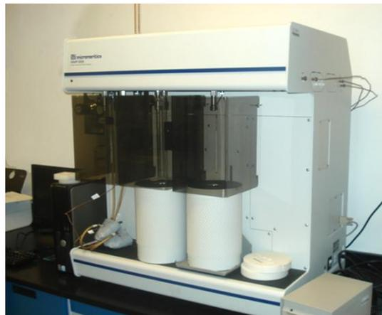
**Figura 2.13.** Equipo de fisisorción Micromeritics ASAP 2020.
