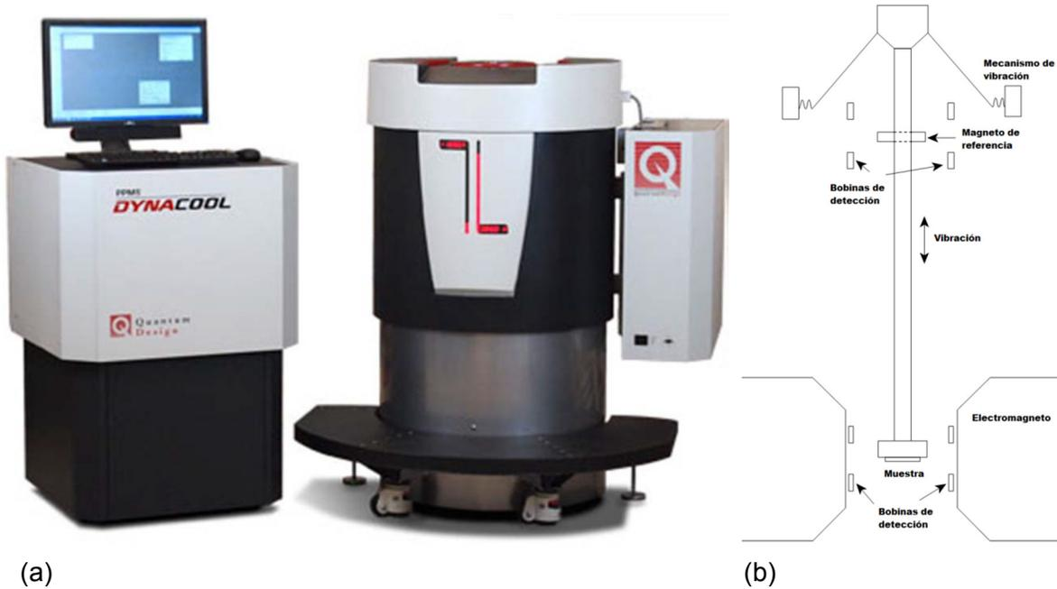
**Figura 2.4.** (a) Plataforma Quantum Design PPMS® modelo Dynacool®-9T. (b) Esquema del magnetómetro de muestra vibrante [10].
