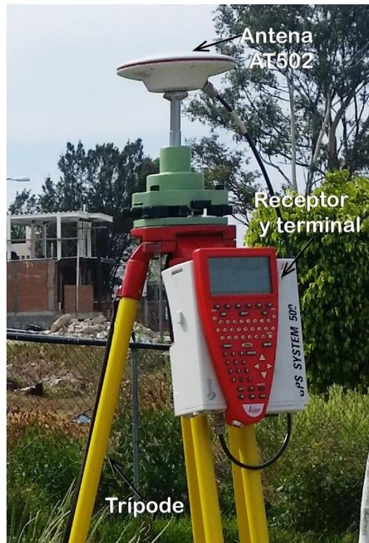
Figura B1 Equipo GPS utilizado durante las campañas de monitoreo en Las Pilas y Jungapeo, Mich.
