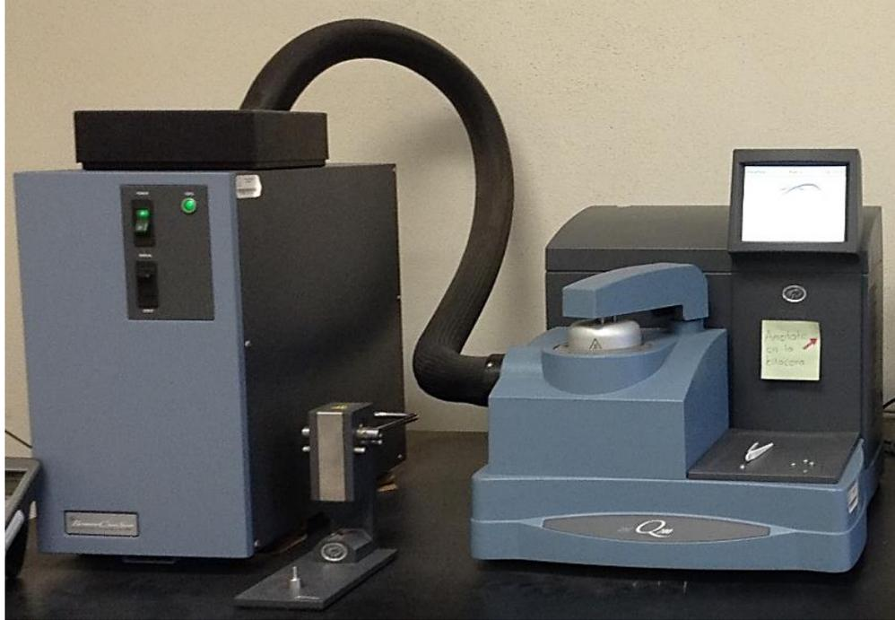
**Figura 2.6.** Calorímetro TA Q200 de la firma TA Instruments empleado para obtener las curvas de calorimetría de las muestras que se estudian en el presente trabajo
