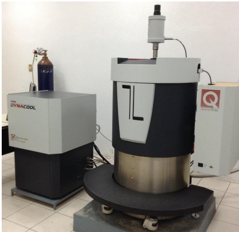
**Figura 2.8.** Plataforma de medición de propiedades físicas modelo DynaCool™ 9 T de la firma Quantum Design empleada para la caracterización magnética de las muestras estudiadas en la presente tesis.
