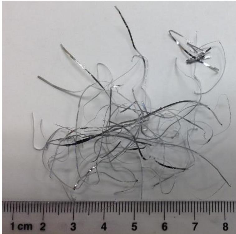
**Figura 2.2.** Cintas de  $\text{Fe}_{49.5}\text{Rh}_{50.5}$  obtenidas por la técnica de temple rotatorio.
