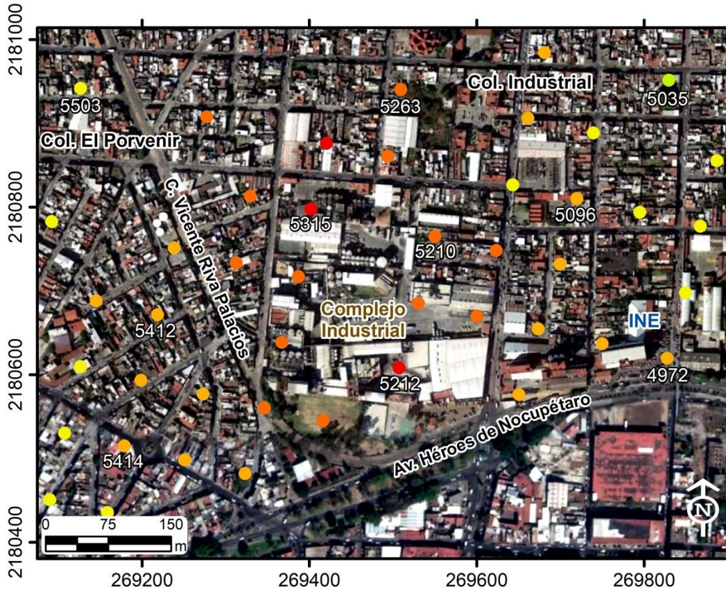
Fig. 7.4. Zona B, SBAS. El hundimiento más crítico (PS 5315) reportado por el análisis SBAS se presenta en este complejo industrial del centro de Morelia, el cual se localiza muy cerca de la traza de la falla Nocupétaro (en el bloque caído).
