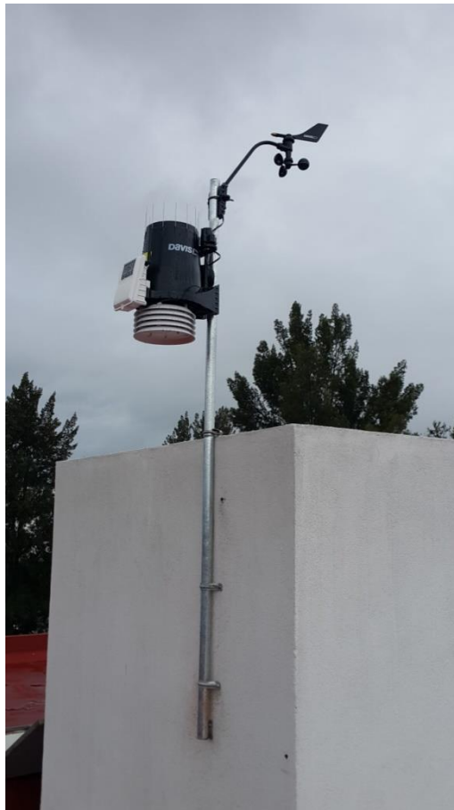
Fig. 7.43. Estación meteorológica Vantage Pro 2 instalada en ciudad universitaria de la UMSNH. La estación utiliza un espectro amplio de radio frecuencia variable para transmitir información de manera inalámbrica a una distancia de hasta 300 m. Tiene colector de lluvia (pluviómetro), sensor de temperatura, sensor de humedad y anemómetro.
