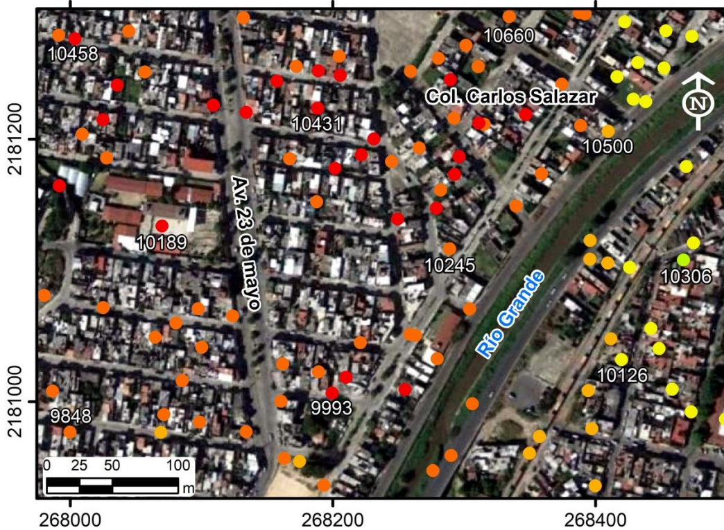
Fig. 7.9. Zona A, PSI. Las colonias Carlos Salazar y Ampliación Carlos Salazar ubicadas cerca del meandro del río Grande son dos de las más afectadas por hundimientos críticos. Esta región coincide con el bloque caído de la falla La Colina considerada una de las más activas en subsidencia.
