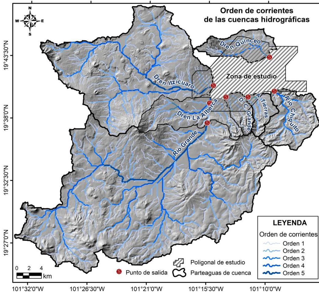
Fig. 7.27. Orden de corrientes de las cuencas hidrográficas de estudio. El patrón de drenaje de las cuencas es de tipo dendrítico, lo que indica la presencia de suelos homogéneos y litologías con una resistencia uniforme a los procesos erosivos.
