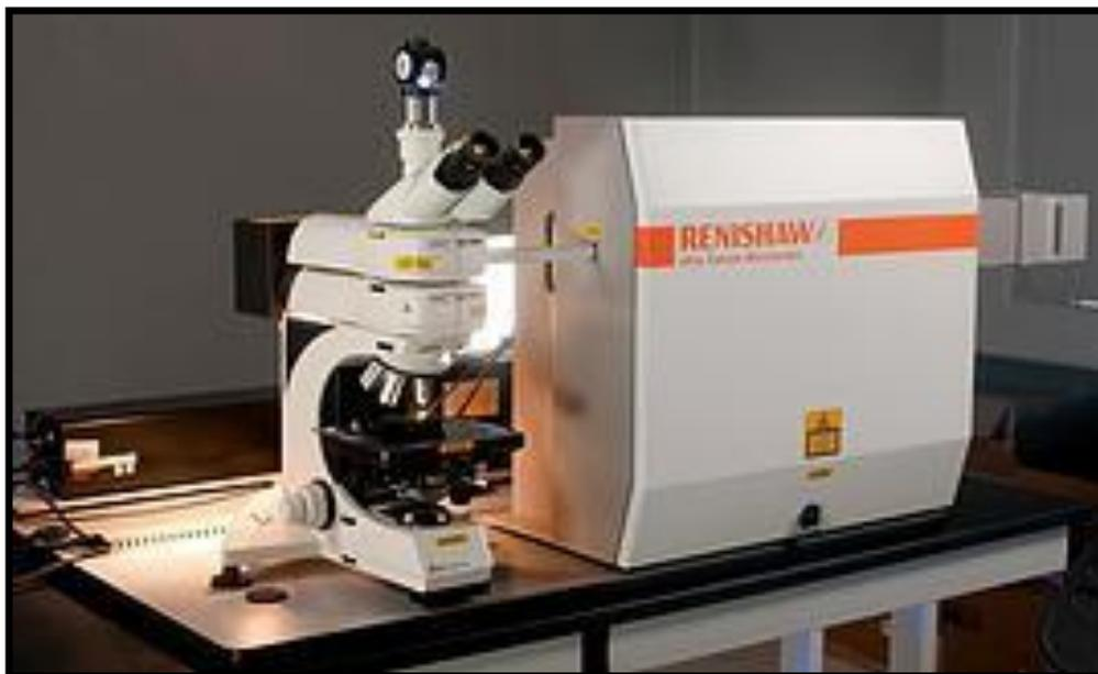
**Figura.A.6.1.** Espectrómetro InVía MICRORAMAN: RENISHAW del Instituto Potosino de Investigación Científica y Tecnológica.
