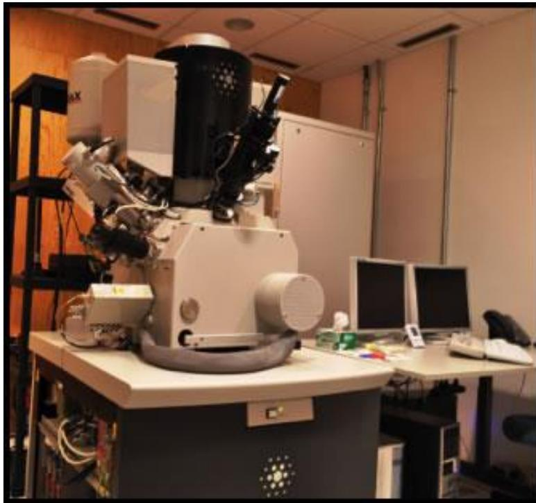
**Figura.A.3.1.** FEI - FIB Dual Beam Helios Nanolab 600 del Instituto Potosino de Investigación Científica y Tecnológica.
