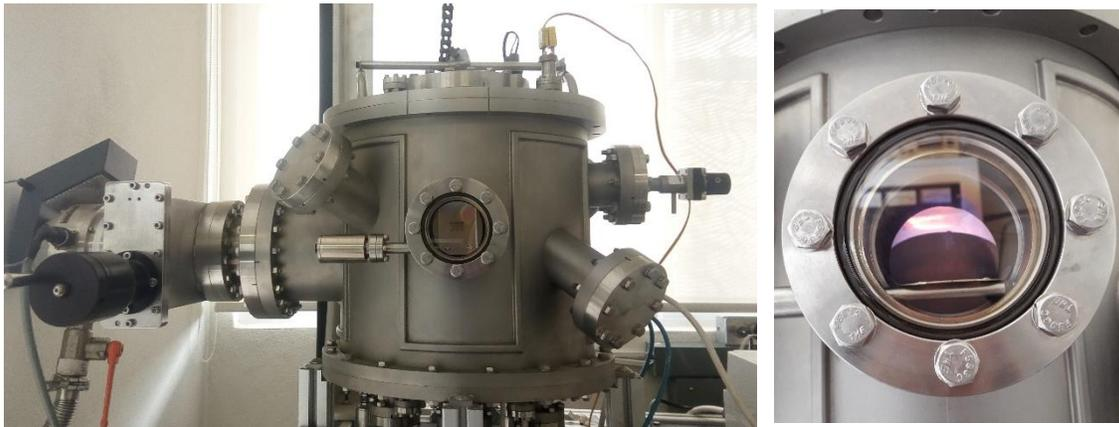
Figura 3. 10 Sistema Sputtering utilizado.
