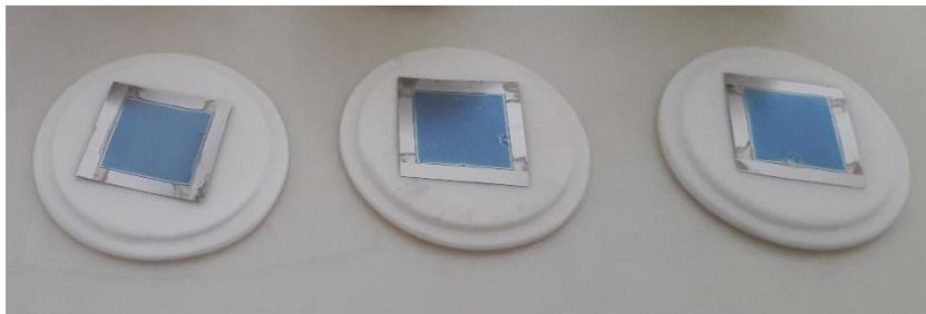
Figura 3. 9 Tres muestras de 3 depósitos de ZrO<sub>2</sub> recocidas por 2 horas a 400 °C.
