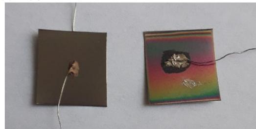
Figura 4. 30 Esquema de la configuración y fotos del capacitor después del segundo corte, área  $210 \text{ mm}^2$ .
