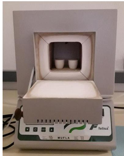
Figura 3. 8 Mufla utilizada para el horneado de las muestras. Mufla FELISA FE-340. a) Cerrada y b) abierta (muestras adentro).
