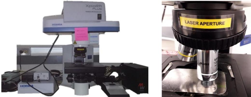
**Figura 2. 8 Microscopio Raman utilizado. XploRA PLUS Raman Microscope de HORIBA Scientific.**
