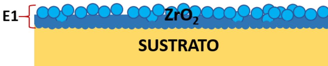
Figura 4. 6 Estructura de capas al cual se aplicó el modelo utilizado para realizar las mediciones de la película  $ZrO_2$ /Hastelloy.
