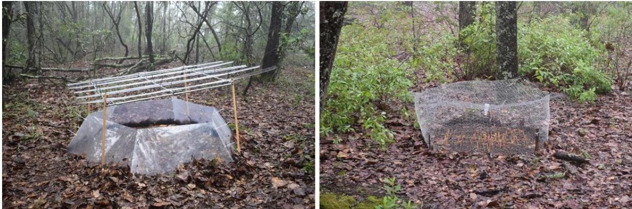
**Figura 3.1.** Parcelas experimentales montadas en el campo. La imagen de la izquierda muestra una parcela de simulación de cambio climático que consiste en una cámara de techo abierto (para aumentar la temperatura) y un refugio de lluvia (para disminuir la precipitación), mientras que a la derecha se muestra una parcela de control cercada con malla de alambre.
