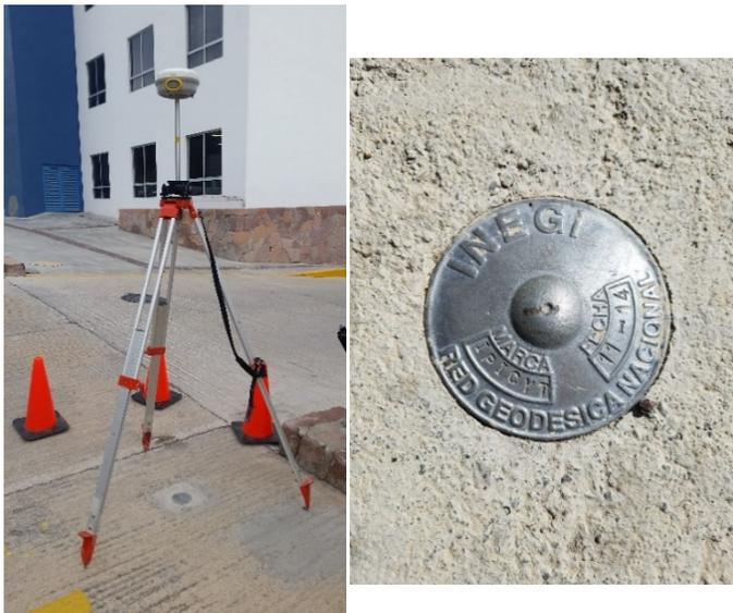
*Fig. 30 Base G.P.S. y gravimétrica en I.P.I.C.Y.T.*
