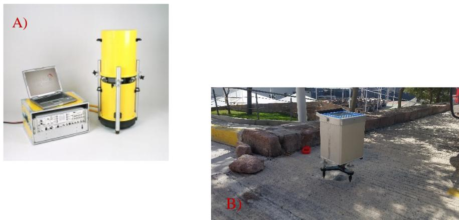
*Fig. 19 A) gravímetro absoluto y B) gravímetro relativo.*
