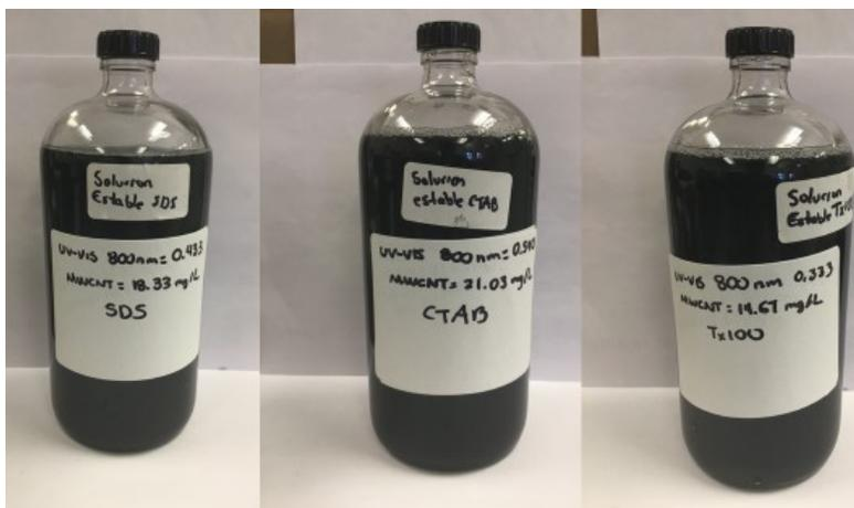
**Figura 29** Suspensiones patrón de NTC obtenidas (SDS, CTAB y Tx-100 respectivamente).
