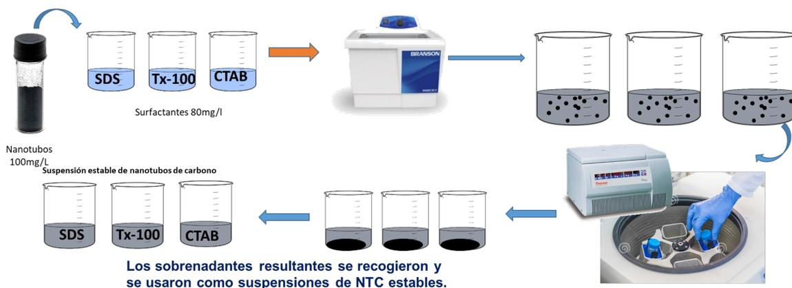
**Figura 28** Proceso llevado a cabo para la obtención de suspensiones estables de NTC
