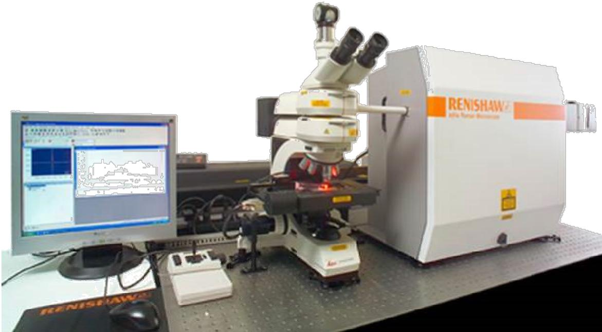
*Figura 22 Espectrómetro InVia: MICRORAMAN:RENISHAW*
