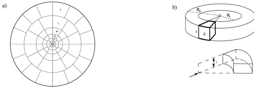
Figura 18. a) Retícula típica usada en el cálculo de corrección por terreno. Una serie de retículas con radio variable de 2 a 21.9 km. b) módulo de elevación diferencia entre el punto de observación y elevación promedio del compartimiento  $z$ , de radio externo e interno  $R_2$ ,  $R_1$  y densidad de corrección de Bouguer  $\rho$ . Tomada de Telford, et al. 1990.
