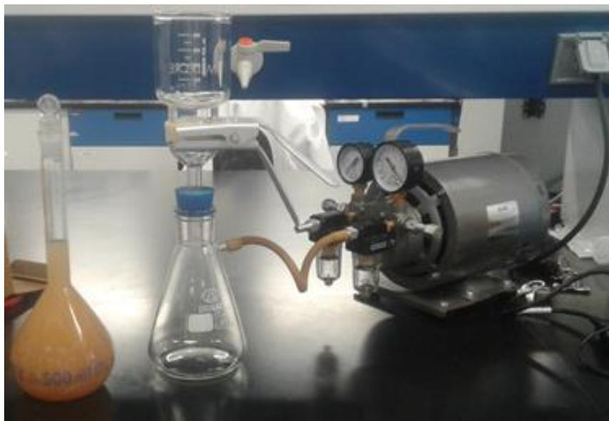
*Figura 5 .3 Fotografía del sistema de filtración milipore*
