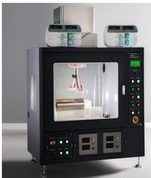
*Figura 5.2 Equipo de electrospinning*
