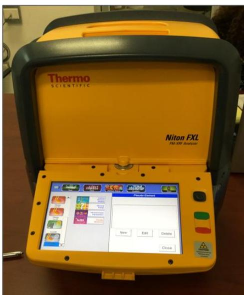
*Figura 9. Equipo portátil de fluorescencia de rayos X (PXRF) ThermoScientific Niton FXL.*
