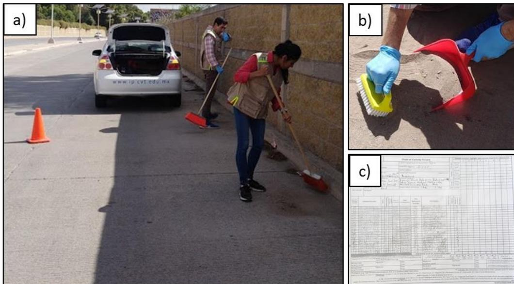
Figura 7. a) Recolección de muestra de polvo urbano en un área de 2x2 m<sup>2</sup> utilizando cepillos y b) colectores de polietileno así como el registro de la misma en la c) cadena de custodia.
