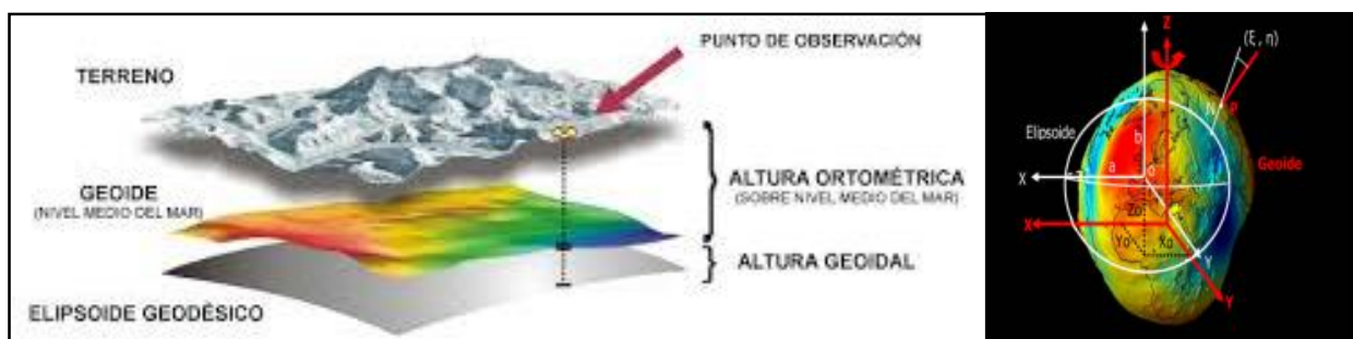
Figura 4.10 Configuración de las superficies de referencia dadas por el elipsoide y el geoide. Nótese el ajuste mayor de la masa continental con el geoide (modificada de Furonés, 2011).
