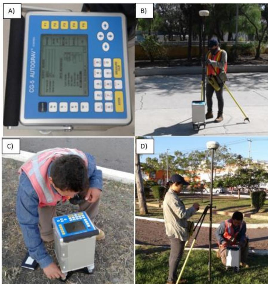
**Figura 29. A) y C) Representación de Gravímetro durante medición. B) y D) Uso de GPS diferencial durante la segunda campaña.**
