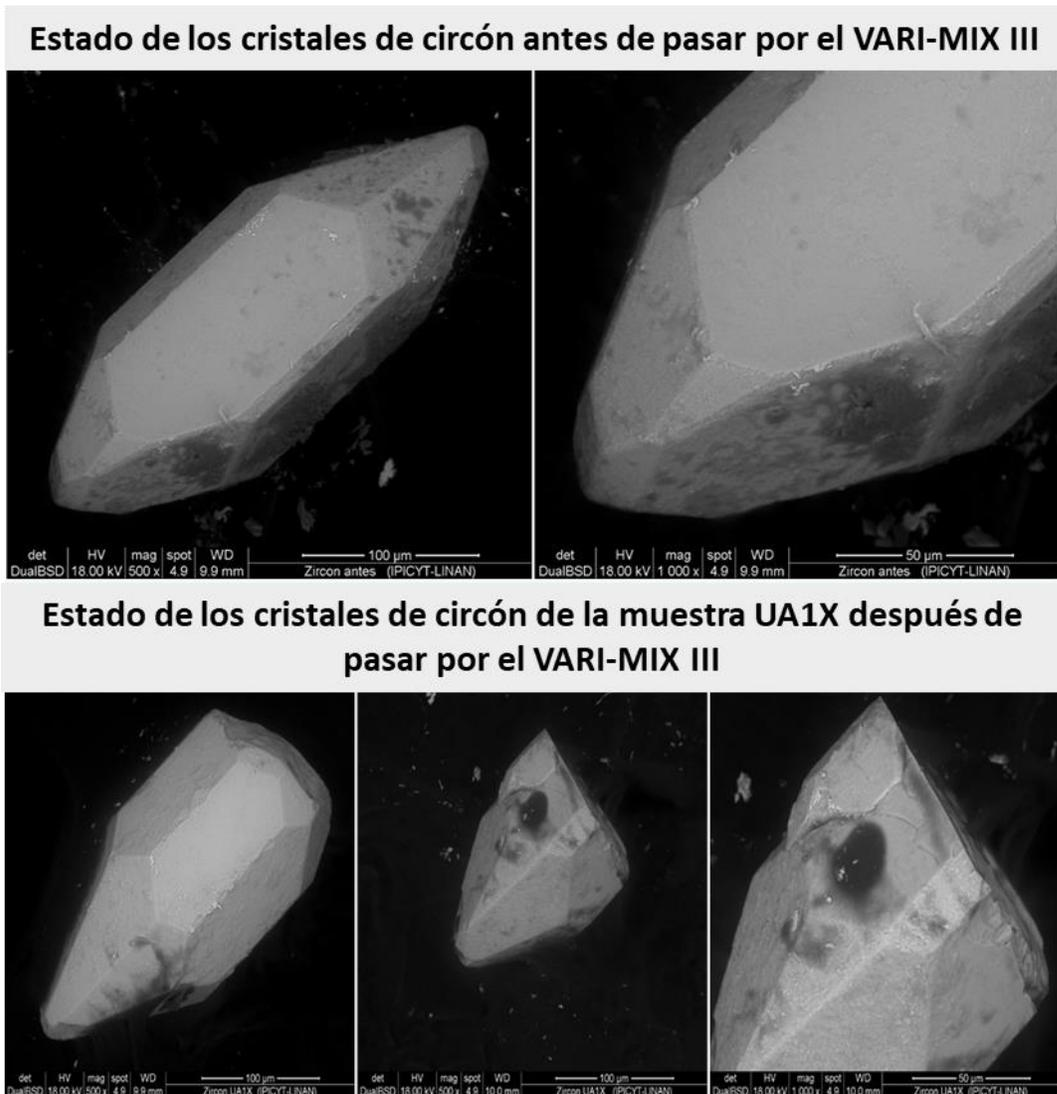
*Figura 13. Comparación del estado inicial y final de los cristales de circón sometidos a la trituración en el VARI-MIX III.*
