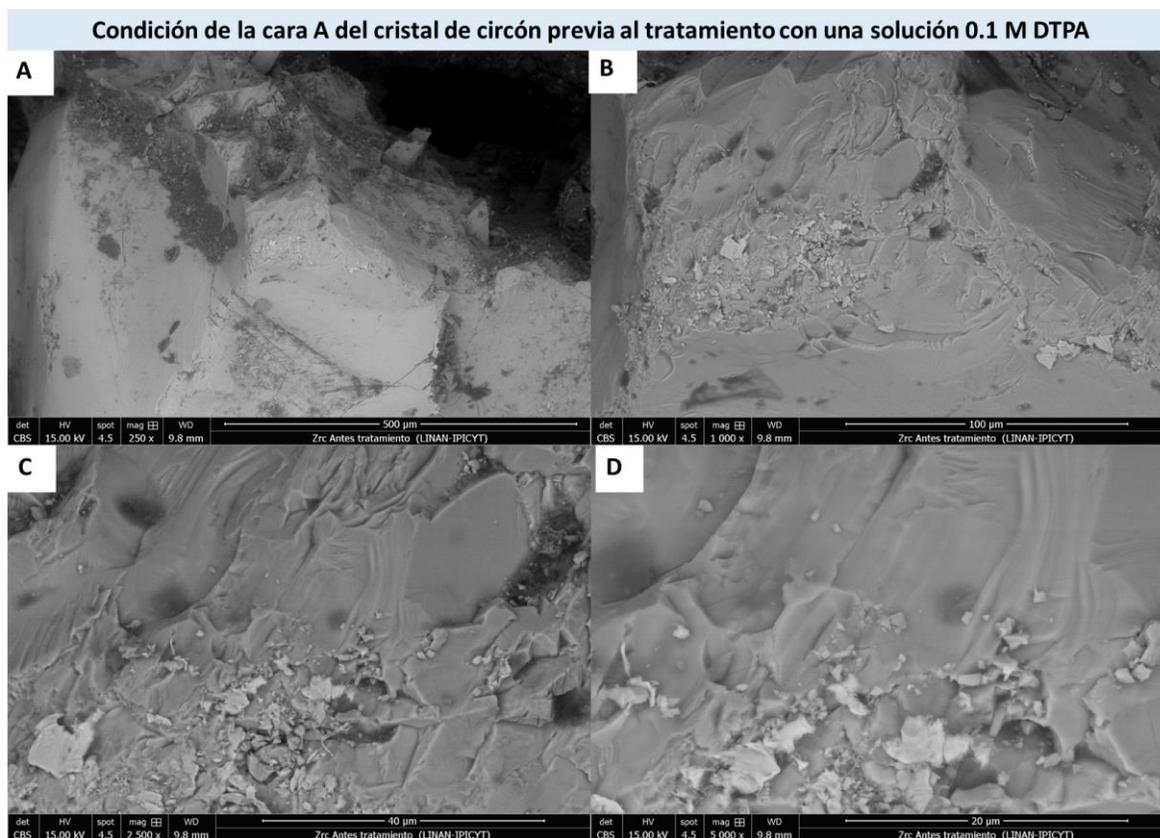
Figura 21. Imágenes de electrones retrodispersados tomadas en la cara A del cristal antes de someter al circón al tratamiento con DTPA y  $K_2CO_3$ . En todas las fotografías se observa que la superficie tiene manchas. A) Imagen con magnificación de 250 X. B) Imagen con magnificación de 1 000 X. C) Imagen con magnificación de 2 500 X. D) Imagen con magnificación de 5 000 X.
