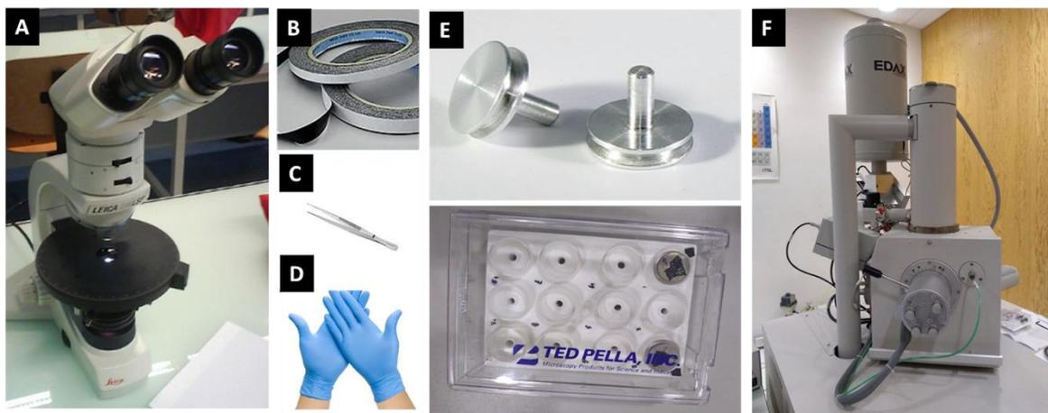
Figura 11. Materiales utilizados en la preparación de la muestra observada en el SEM. A) Microscopio binocular. B) Cinta de carbono. C) Pinzas. D) Guantes. E) Pin, lugar en donde se adhieren los cristales. F) Microscopio electrónico de barrido ESEM FEI QUANTA 100.
