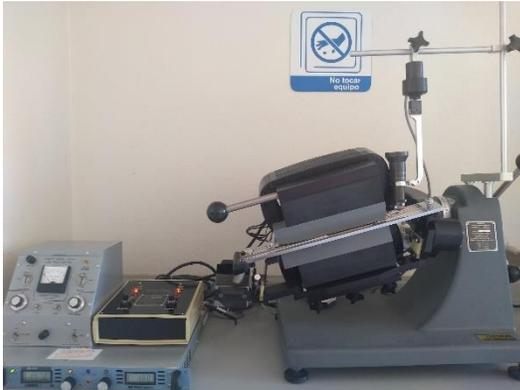
*Figura 9. Separador magnético "Frantz" usado para segregar la fracción magnética y la no magnética de la roca.*
