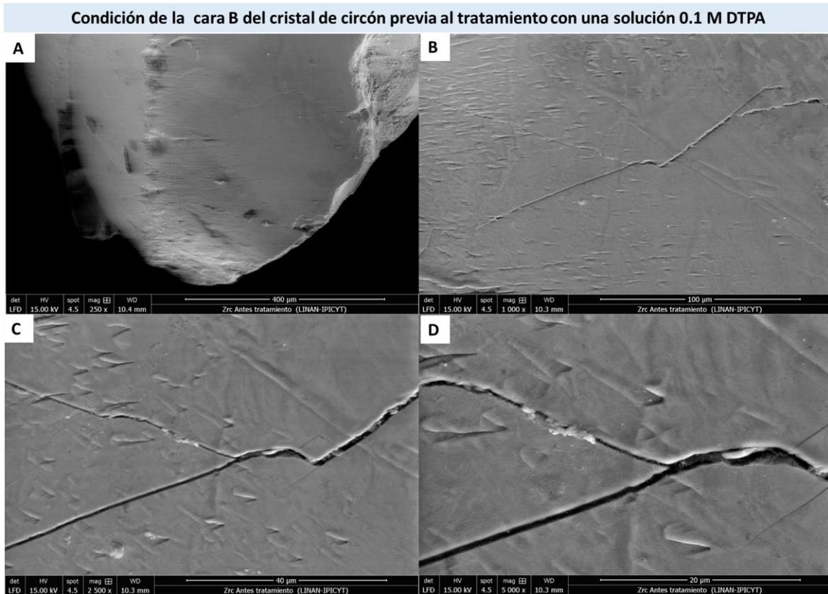
Figura 27. Fotografía de la cara B del cristal tomada con la técnica de electrones secundarios previa al tratamiento con una solución 0.1 M DTPA y  $K_2CO_3$ . A) Imagen con magnificación de 250. B) Imagen con magnificación de 1 000 X. C) Imagen con magnificación de 2 500 X. D) Imagen con magnificación de 5 000 X.
