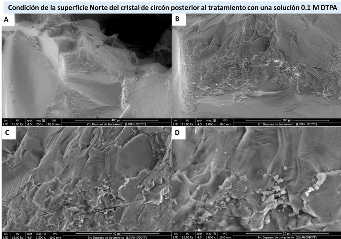
Figura 24. Imágenes tomadas de la superficie norte del cristal con la técnica de electrones secundarios. Aquí se muestra la apariencia del cristal después de exponerse al tratamiento con una solución 0.1 M DTPA y  $K_2CO_3$  con un tiempo de ebullición de 60 minutos. A) Imagen con magnificación de 250. B) Imagen con magnificación de 1 000 X. C) Imagen con magnificación de 2 500 X. D) Imagen con magnificación de 5 000 X.
