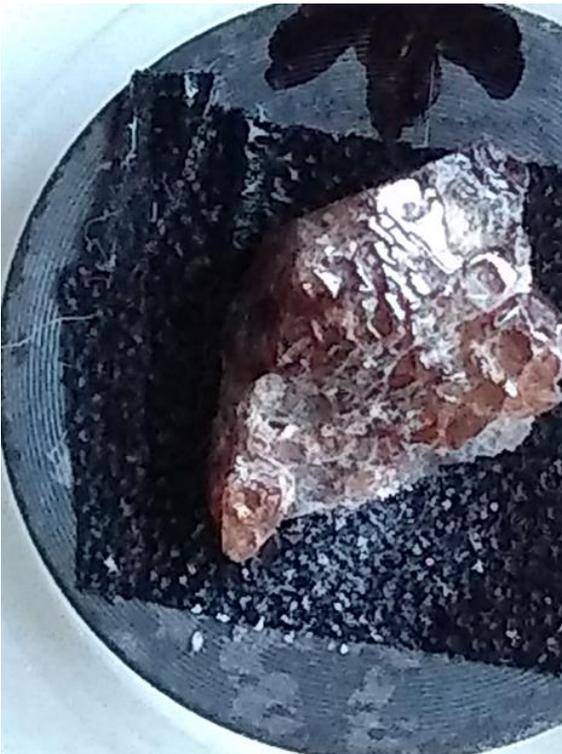
*Figura 12. Cristal de circón montado de forma orientada en un pin para su observación en el SEM. La flecha negra señala la forma la en la que el cristal está orientado.*
