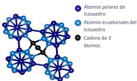
Fig. 4 Estructura romboédrica general del BC. muestra la cadena central de 3 átomos, los átomos polares y ecuatoriales dentro de la estructura, General. Realizado en Vesta.
