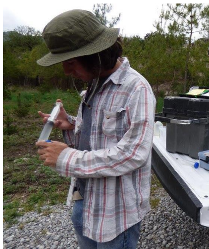
Figura 4.5. Toma de muestras de agua subterránea para su análisis iónico, las muestras se filtran mediante una jeringa con un filtro adaptado con tamaño de poro de 0.45\mu\text{m} .
