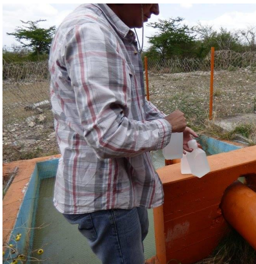
Figura 4.6. Toma de muestra de agua subterránea para su análisis isotópico.
