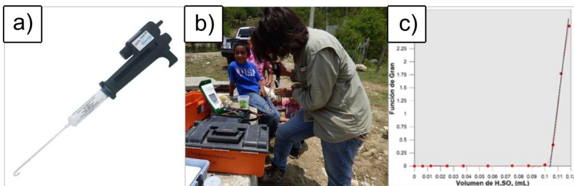
Figura 4.4. Determinación de HCO_3^- por titulación y método de Gran. a) Titulador digital HACH AL; b) Titulación en campo por método de GRAN (medición de pH mientras se agrega ácido a la muestra); c) Gráfico con la función de Gran para calcular el volumen de H_2SO_4 .
