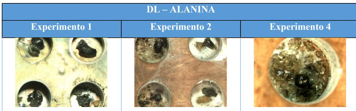
**Figura 17.** Imágenes de algunos orificios del portamuestras donde se aprecia el micrometeorito formado, los silicatos que no fundieron y el aminoácido remanente posterior al proceso de fusión. Nótese que el aminoácido remanente no se filtra debajo de los micrometeoritos experimentales o cristales de más de 250  $\mu\text{m}$  (experimentos 1 y 2, columna derecha) mientras que en los cristales de menos de 250  $\mu\text{m}$  se conserva intersticialmente.
