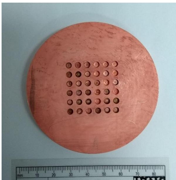
**Figura 4.** Portamuestras de cobre utilizado para realizar los fundidos experimentales de micrometeoritos ultracarbonáceos. Dentro de los orificios del portamuestras se agregan los silicatos y la alanina para posteriormente ser fundidos con el láser de CO<sub>2</sub>.
