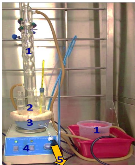
Figura 8. Sistema de síntesis de BiOCl. 1) Sistema de enfriamiento, 2) reactor, 3) canastilla de calentamiento, 4) sistema de agitación, 5) termostato.
