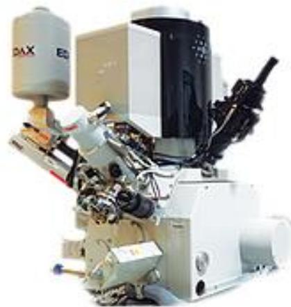
**Figura 2.6** Microscopio electrónico de barrido (FEI-Helios NanoLab Dual. Beam 600).
