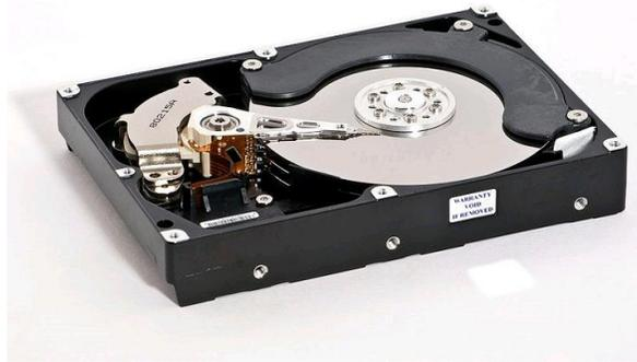
**Figura 1.** Disco duro Samsung HD753LJ abierto. [6]
